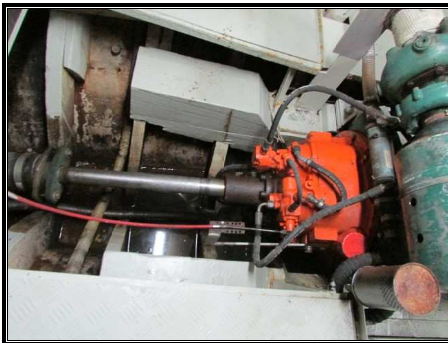
Slika 21. Kopča s pogonskom osovinom
