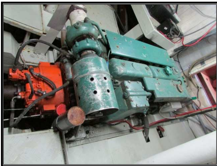
Slika 19. Strojarnica s pogonskim motorom VOLVO PENTA
